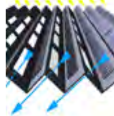
capteurs solaires au sud, verrière au nord
