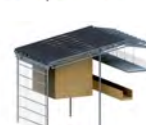
suspension de la façade vitrée
